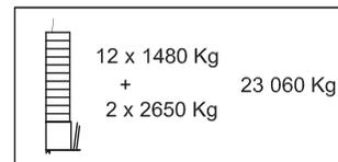
Dead weight without ballast / Konstruktionsgewicht ohne Ballast
